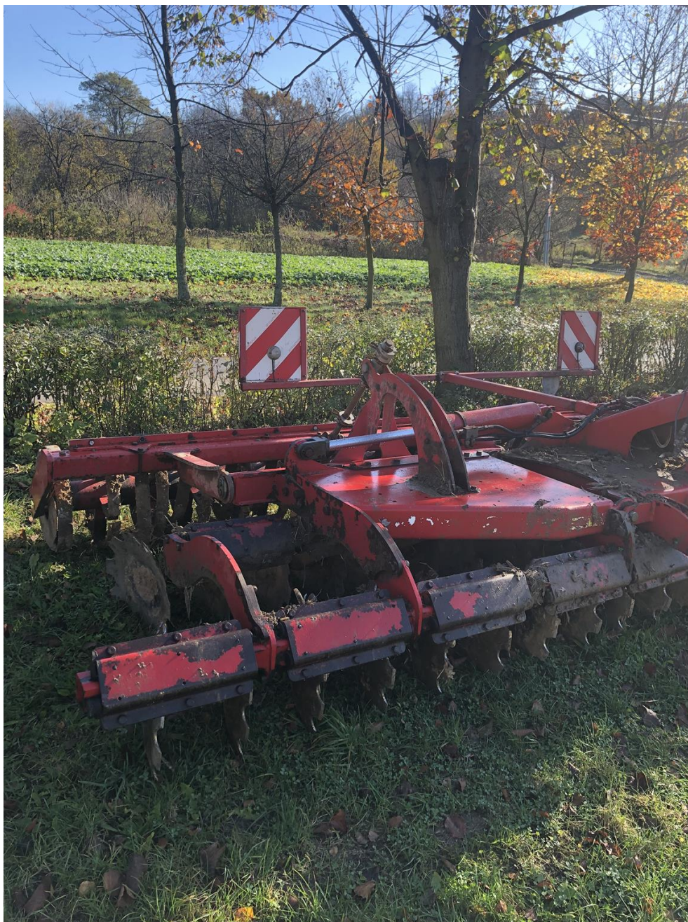
Brona talerzowa marki Horsch z wałem ugniatającym. Agregat posiada 3-punktowy układ łączenia z ciągnikiem, dwurzędową bronę talerzową i jednorzędowy wał ugniatający.
