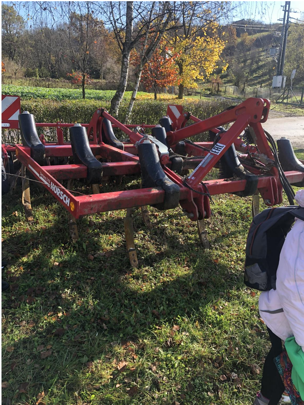
Kultywator marki Horsch o zębach sztywnych z zabezpieczeniami przed uszkodzeniem mechanizmem sprężynowym.
