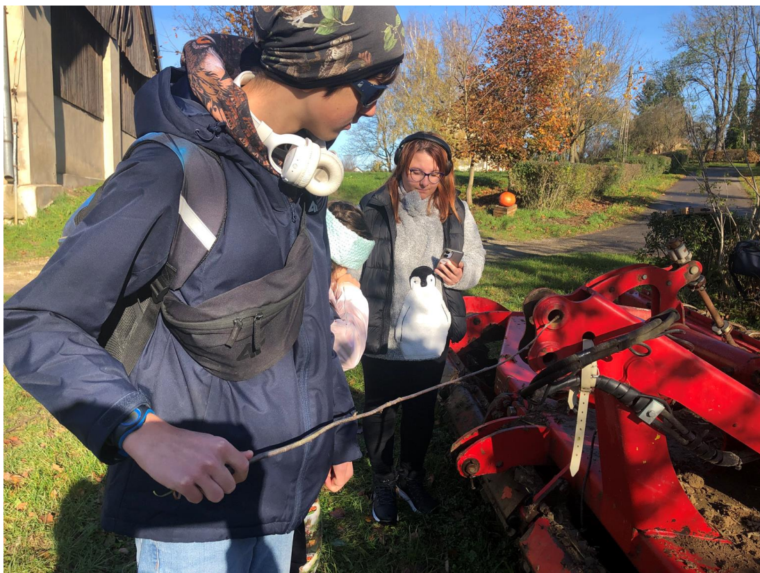
Kuba pokazuje miejsce do górnego łączenia agregatu z ciągnikiem, a Nina dokumentuje poznane wiadomości.
