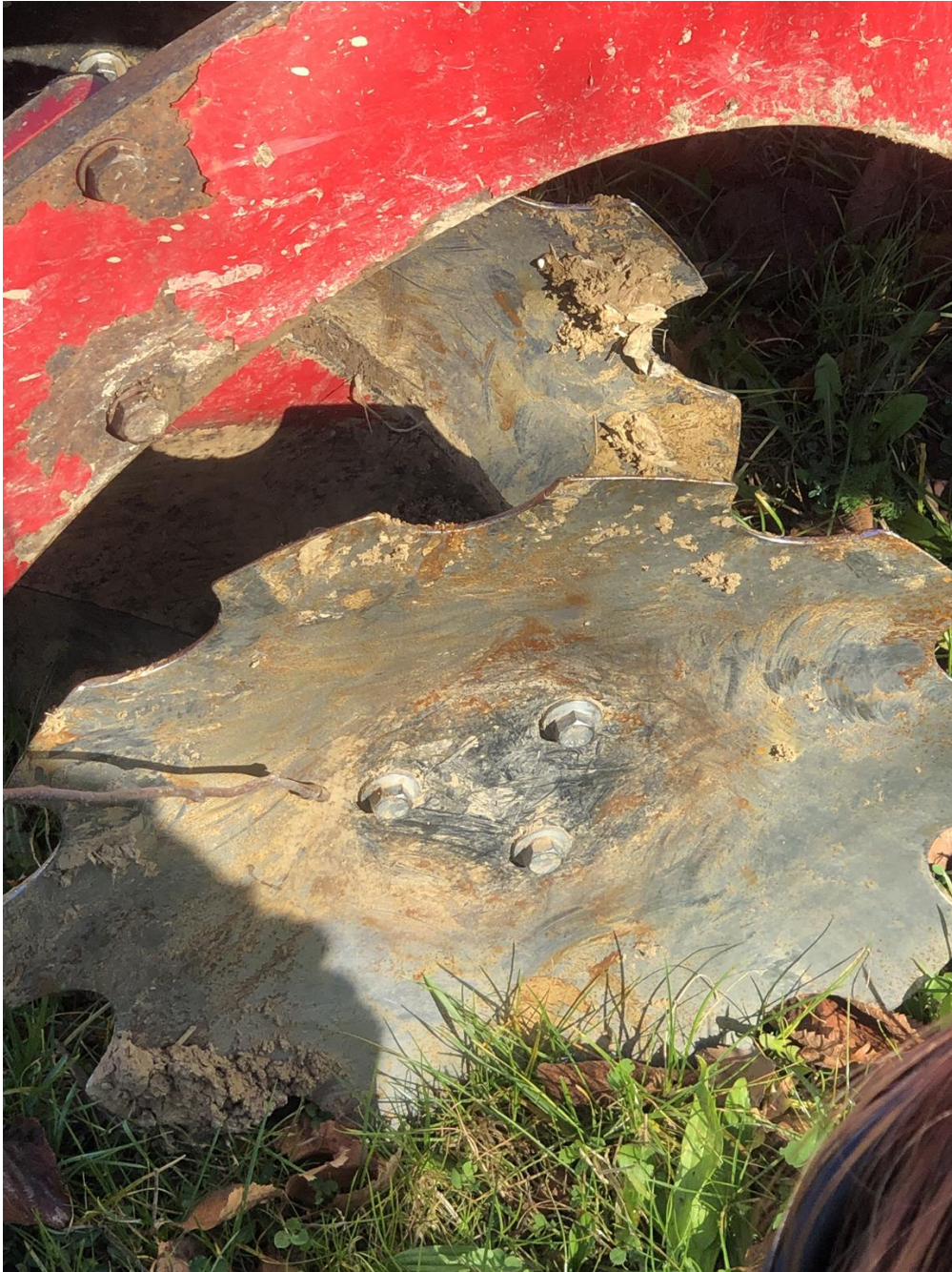
Talerz brony talerzowej odcina niewielkie skiby zadarnionej ziemi, tnie resztki poźniwne i odwraca ziemię.
