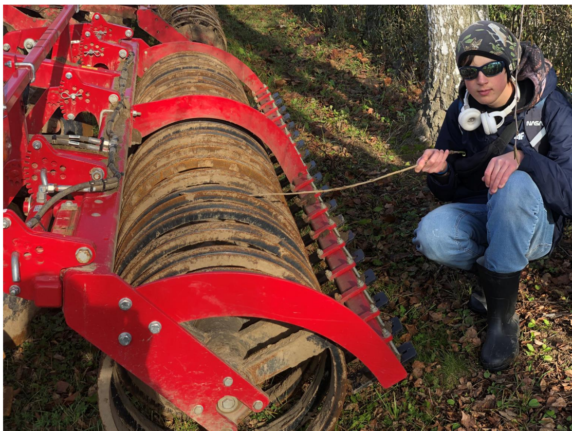
Kuba pokazuje pierścienie wału ugniatającego i wyrównującego spulchnioną ziemię.
