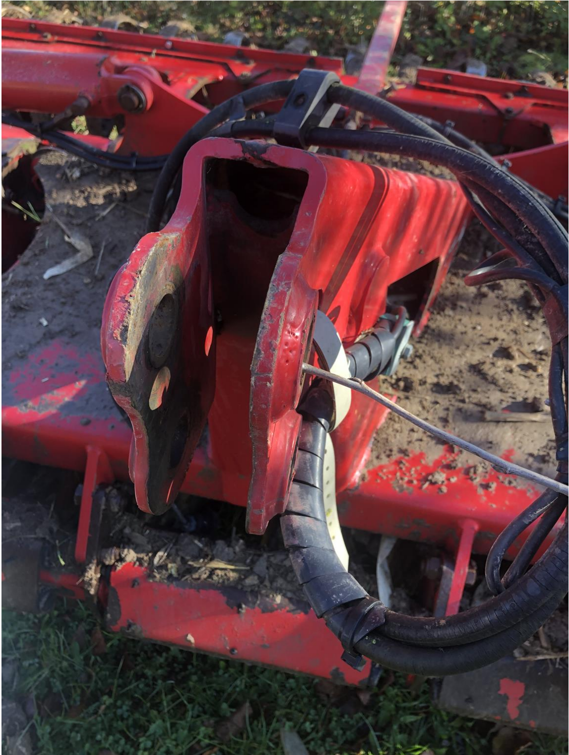
Miejsce do górnego łączenia agregatu z ciągnikiem.
