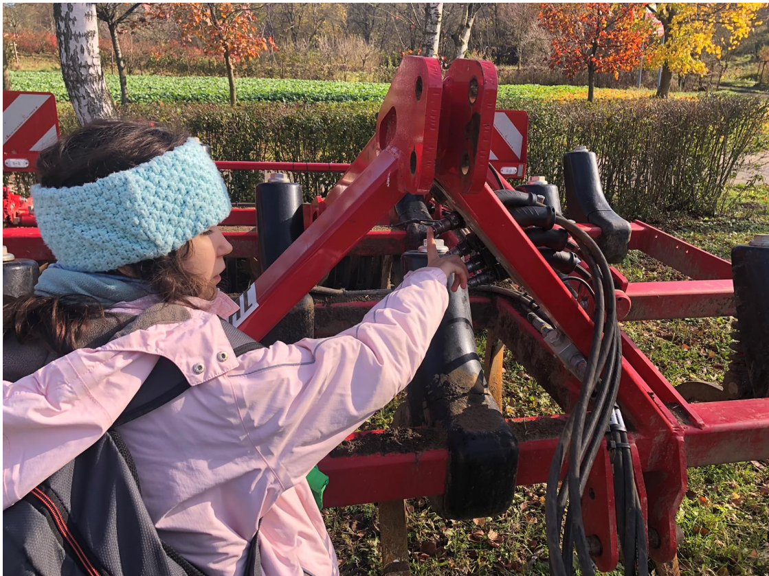
Natalia pokazuje 4 złącza hydrauliczne do podłączenia z ciągnikiem.
