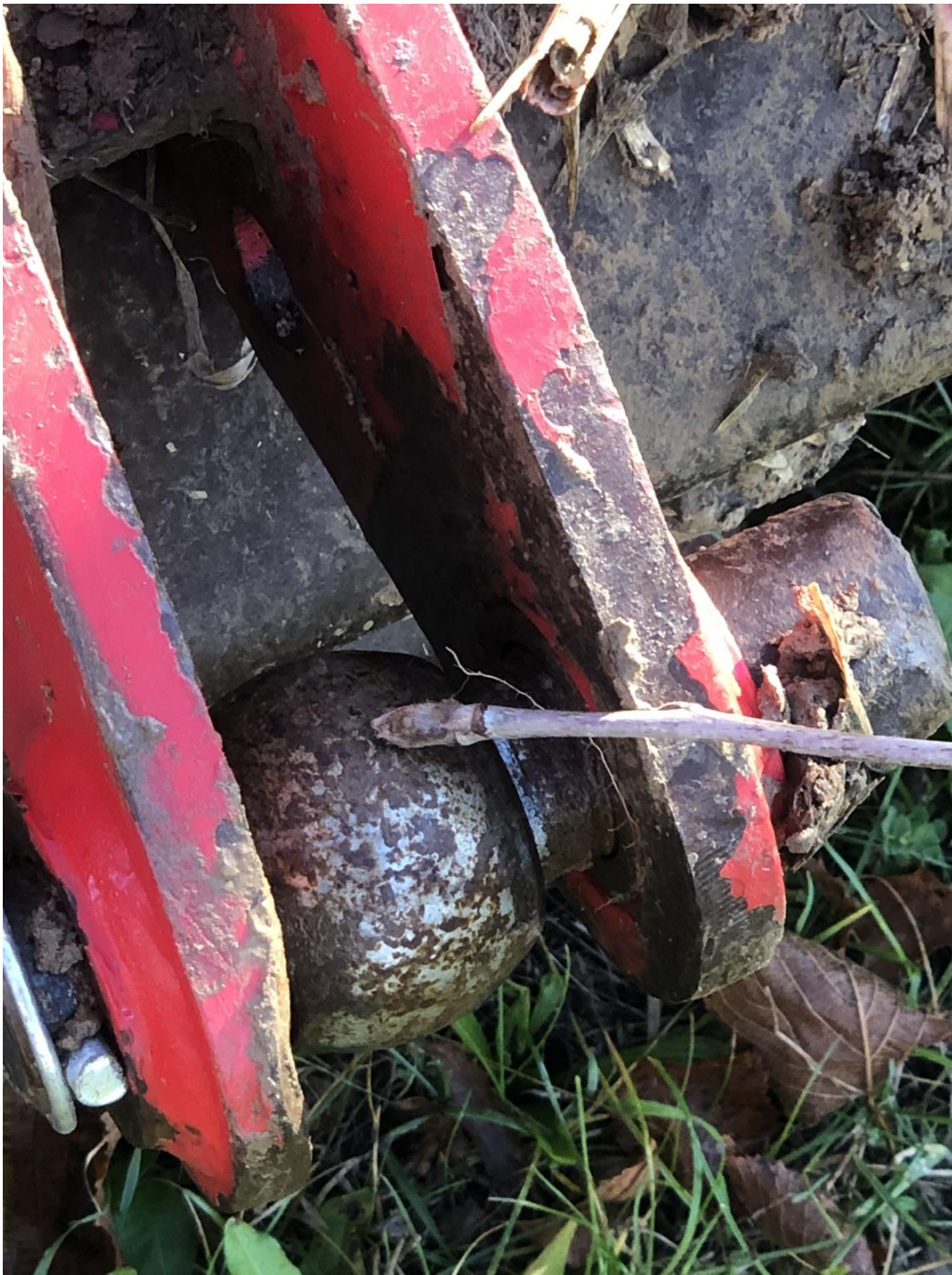
Przegub kulisty 3-punktowego układu zawieszenia
