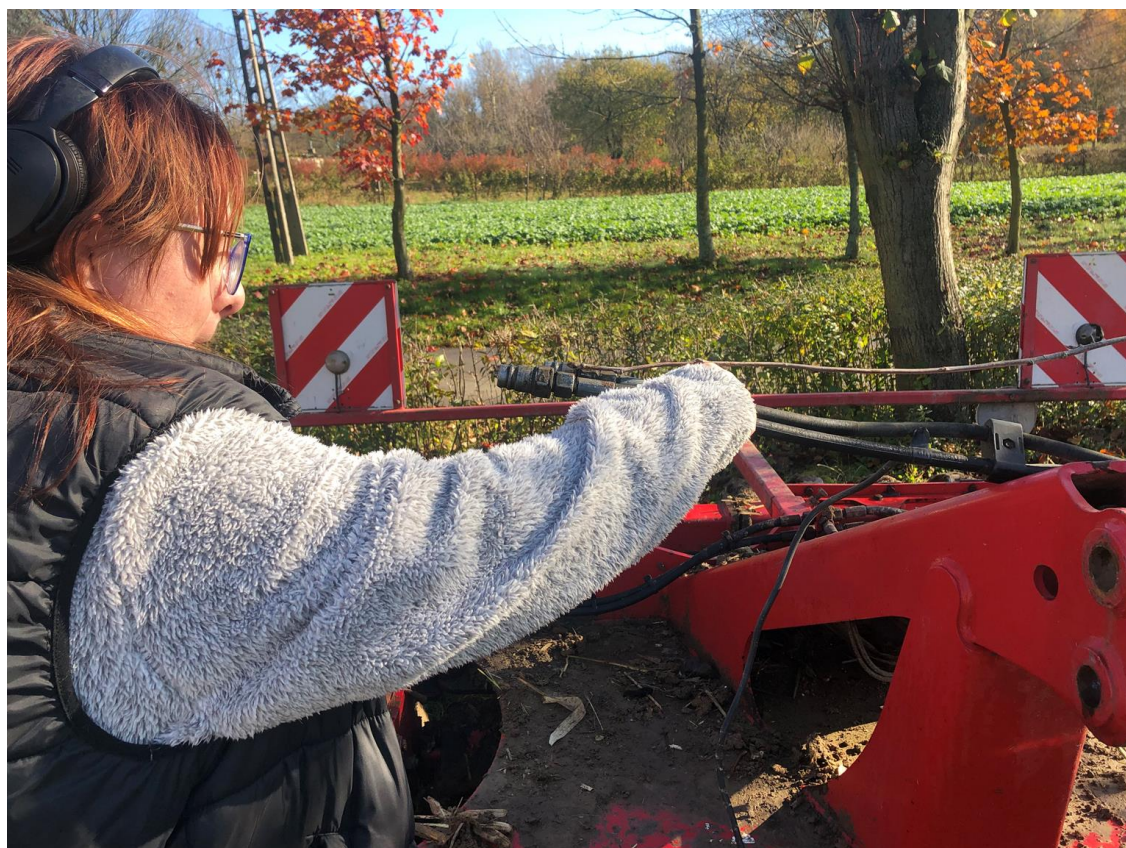
Nina pokazuje 2 złącza hydrauliczne, które podłącza się do ciągnika.
