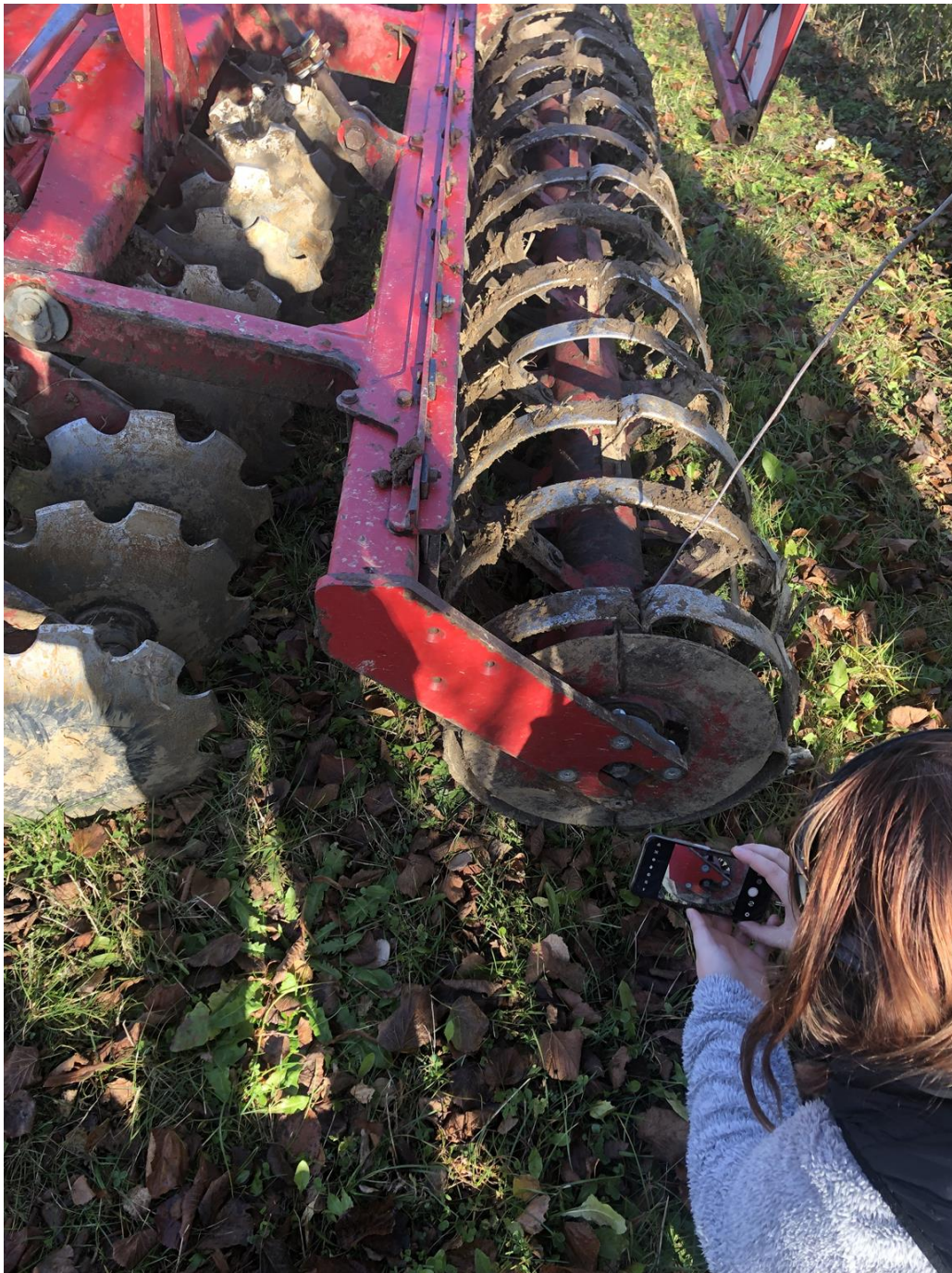
Nina fotografuje pierścienie 2 sekcji agregatu ugniatające rozdrobnioną ziemię.
