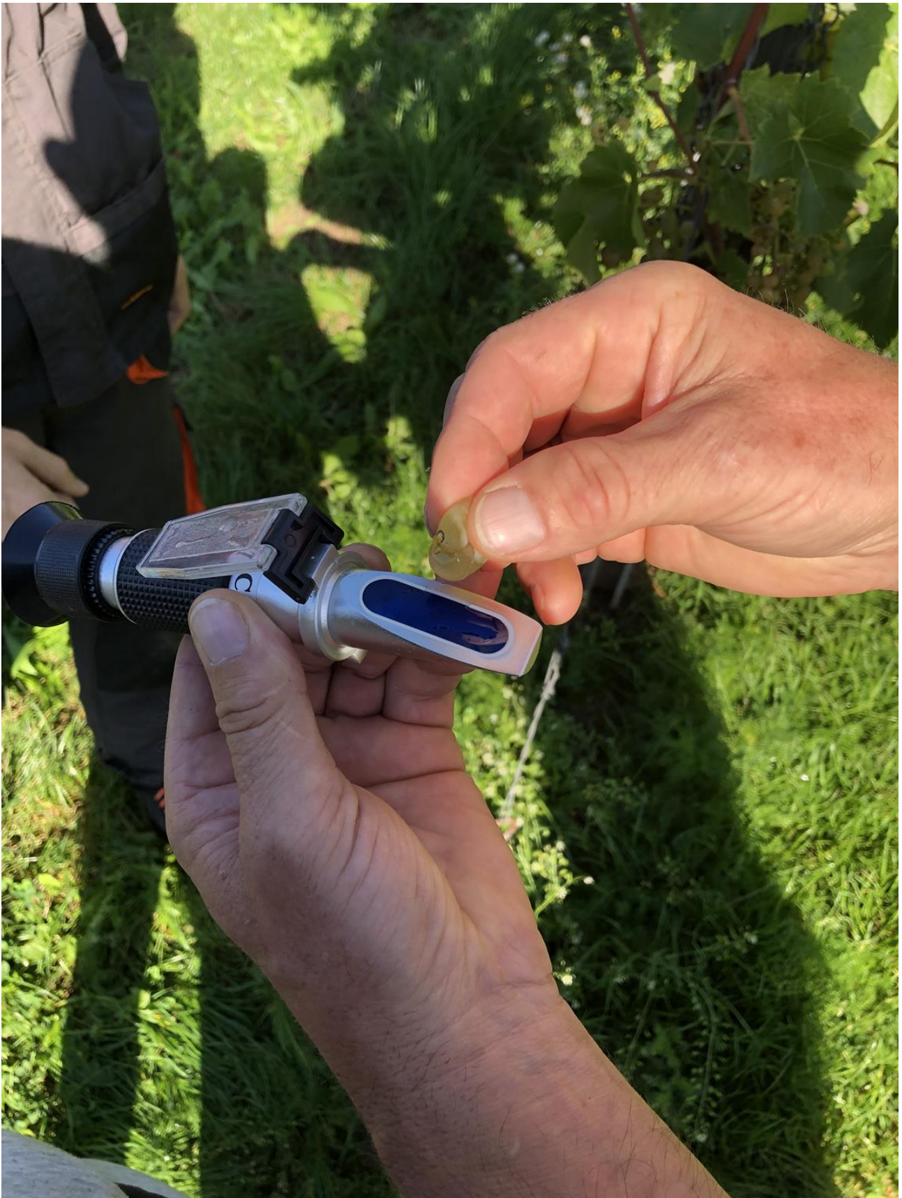
Wyciskanie soku winogronowego na szkiełko refraktometru.
