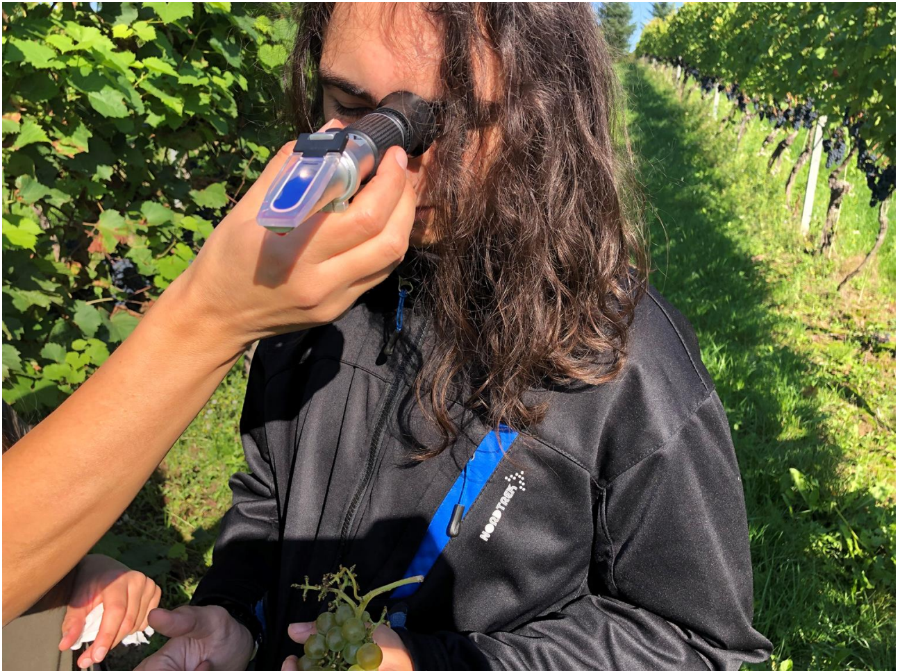
Szymon uczy się patrzeć w okular refraktometru i odczytywać zawartość cukru
