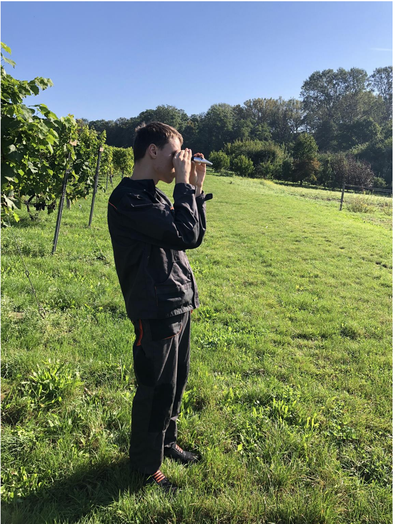
Mierzenie dojrzałości winogrona poprzez pomiar zawartości cukru w soku refraktometrem.
