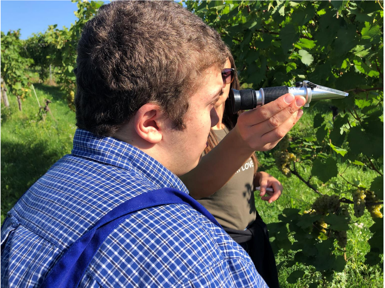
Piotr odczytuje zawartość cukru w soku winogronowym refraktometrem.
