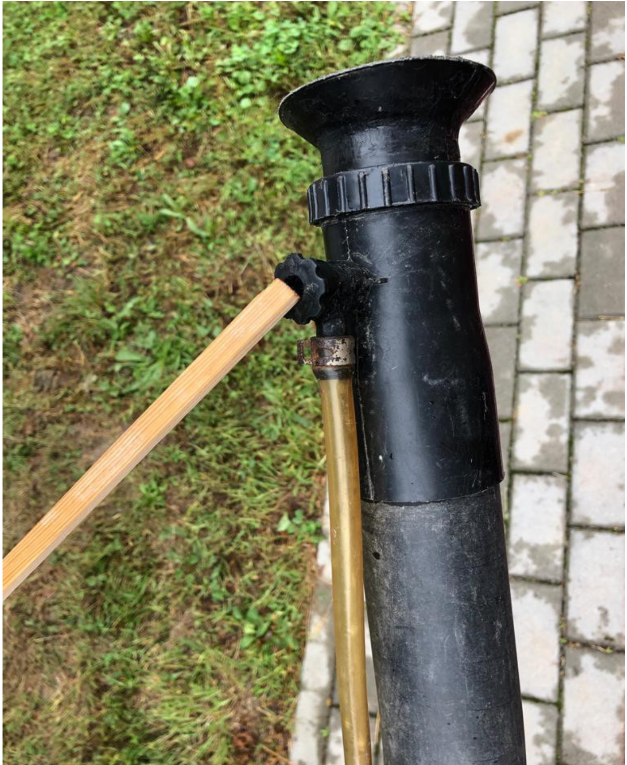
Zawór regulacji ilości cieczy użytkowej kierowanej do dyfuzora. Pomocniczy strumień powietrza wytwarza wentylator napędzany silnikiem. Powietrze jest kierowane do dyfuzora przewodem
