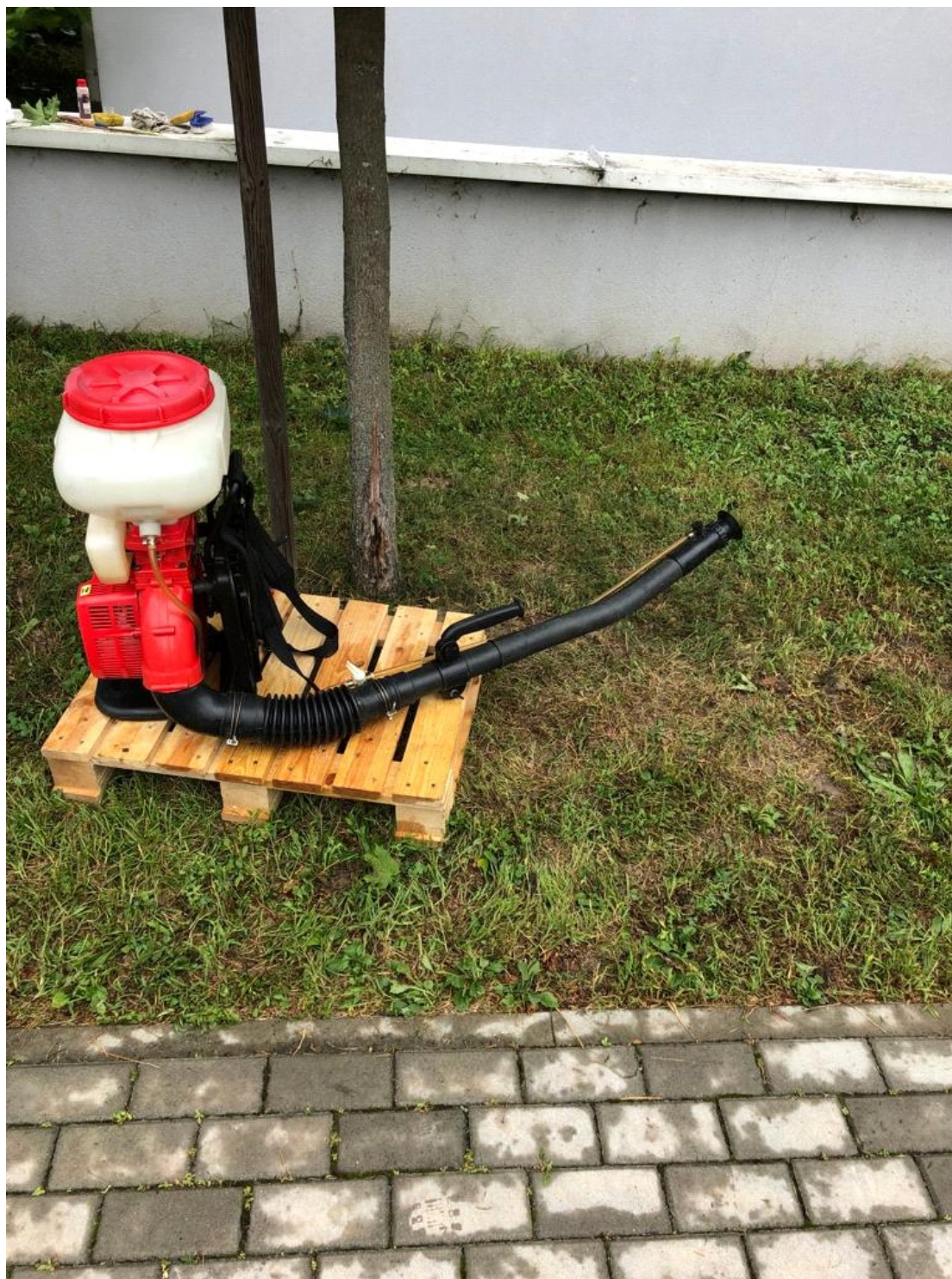
Opryskiwacz plecakowy, silnikowy (z silnikiem spalinowym dwusuwowym z zapłonem iskrowym zasilanym mieszanką benzyny silnikowej i oleju w proporcji 50:1)
