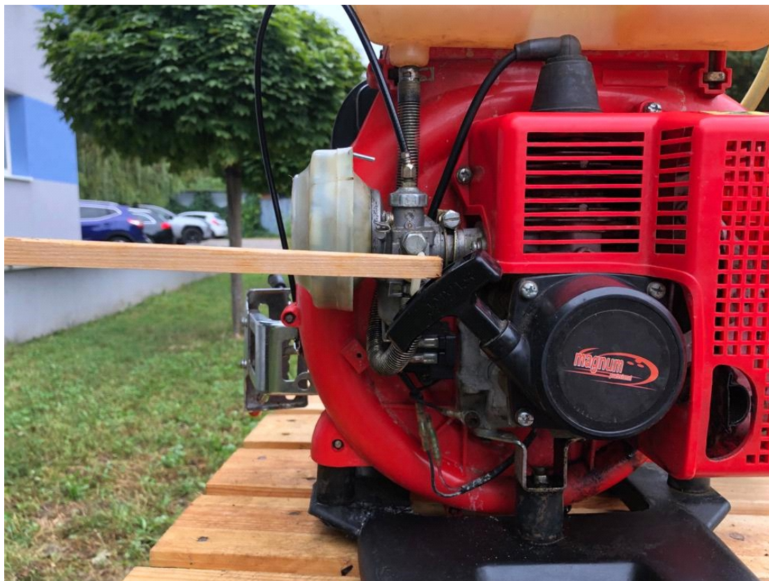
Dźwignia ręcznego rozrusznika silnika spalinowego.
