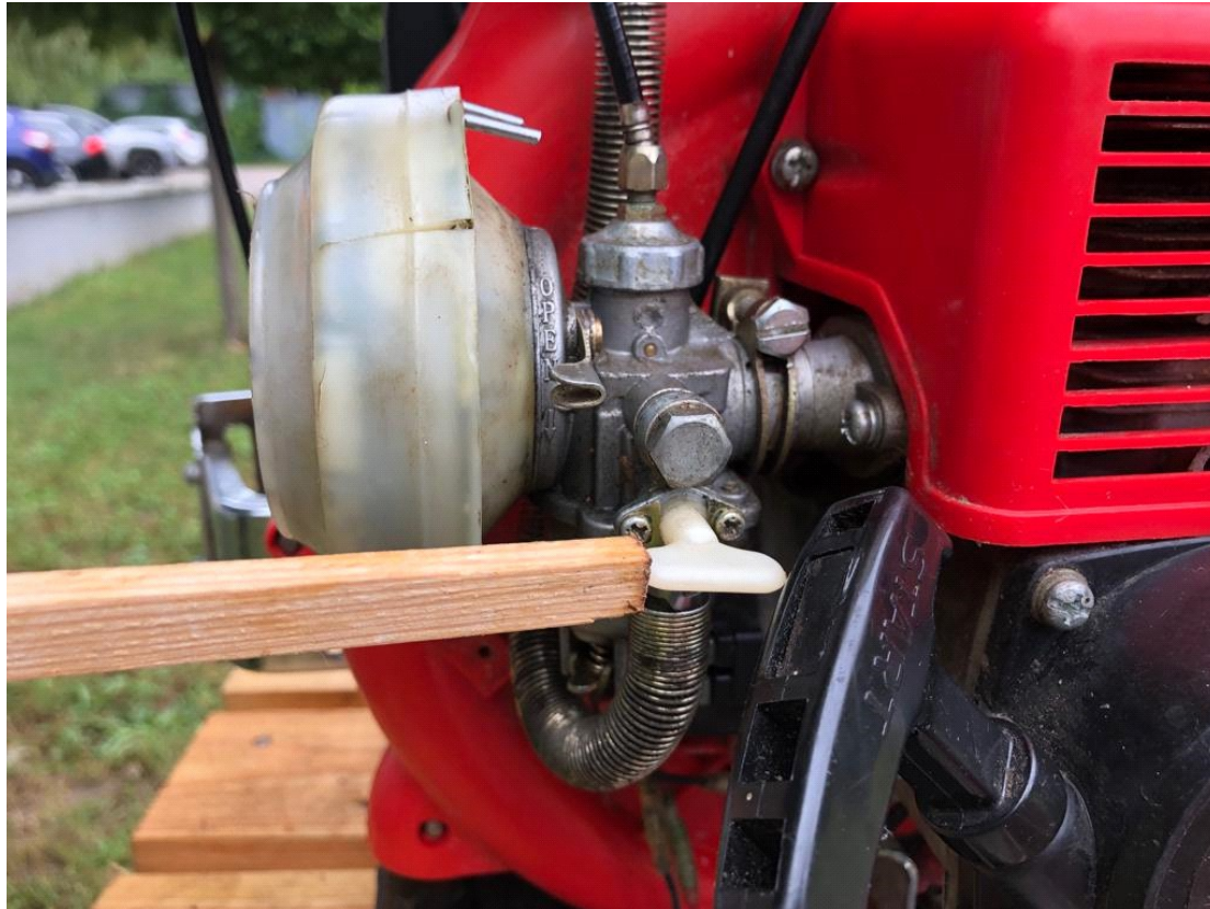
Dźwignia zaworu zamykającego dopływ paliwa do gaźnika.
