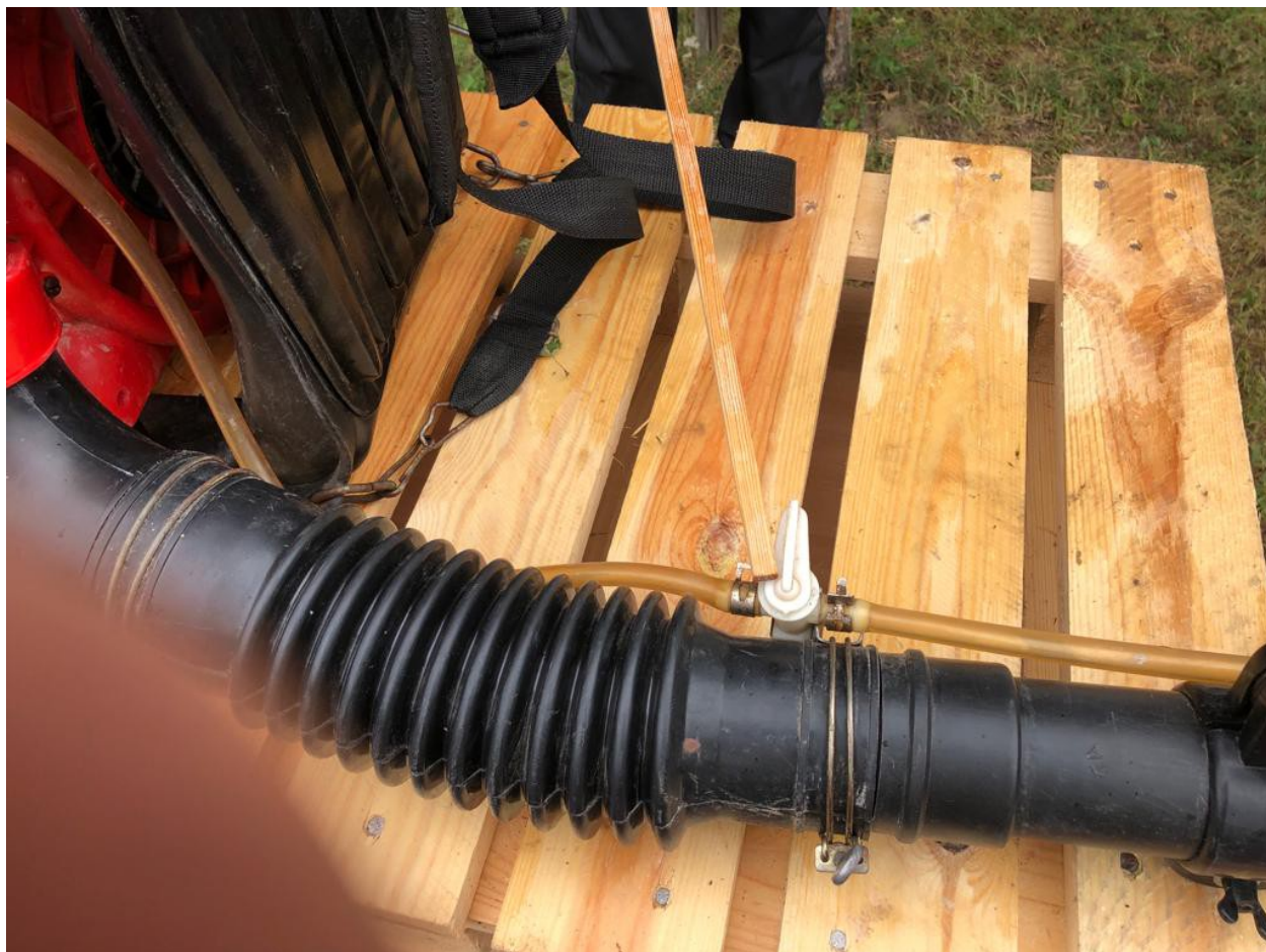
Zawór zamykający i otwierający przepływ cieczy użytkowej ze zbiornika do dyfuzora.
